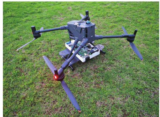
图1 安装在无人机上的空中发射器平台
